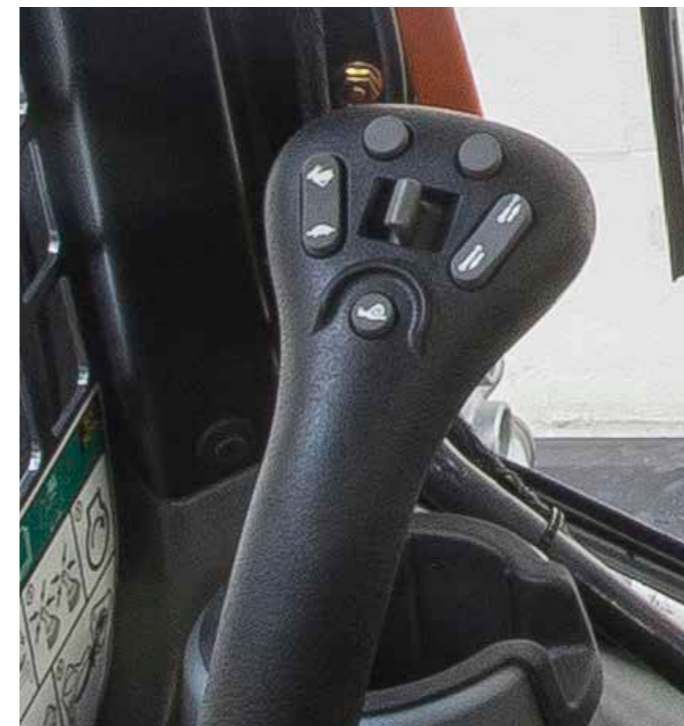
Commandes aux manipulateurs commutables
