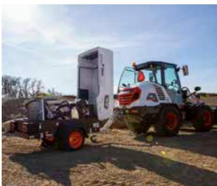
La barre d'attelage pouvant être équipée d'une boule d'attelage ou de toutes sortes d'œilletons de remorquage de tailles variées, vous avez la possibilité de connecter la machine à un grand choix de porteurs.
