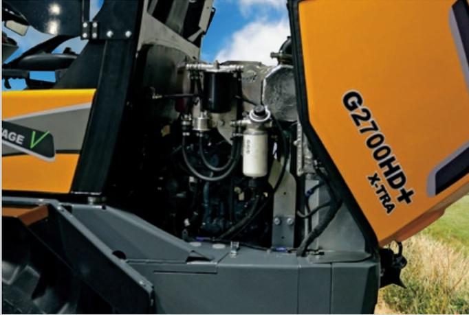
Es ist einfach, die regelmäßig wiederkehrenden Wartungsarbeiten beim G2700 durchzuführen, da die Wartungspunkte gut erreichbar sind. Filter, Hydrauliksystem und Motor sind aufgrund der leicht zu öffnenden Haube und anderer Wartungsklappen direkt zugänglich. Somit wird sichergestellt, dass die täglichen Überprüfungen und Wartungsarbeiten schnell und sicher durchgeführt werden können.
