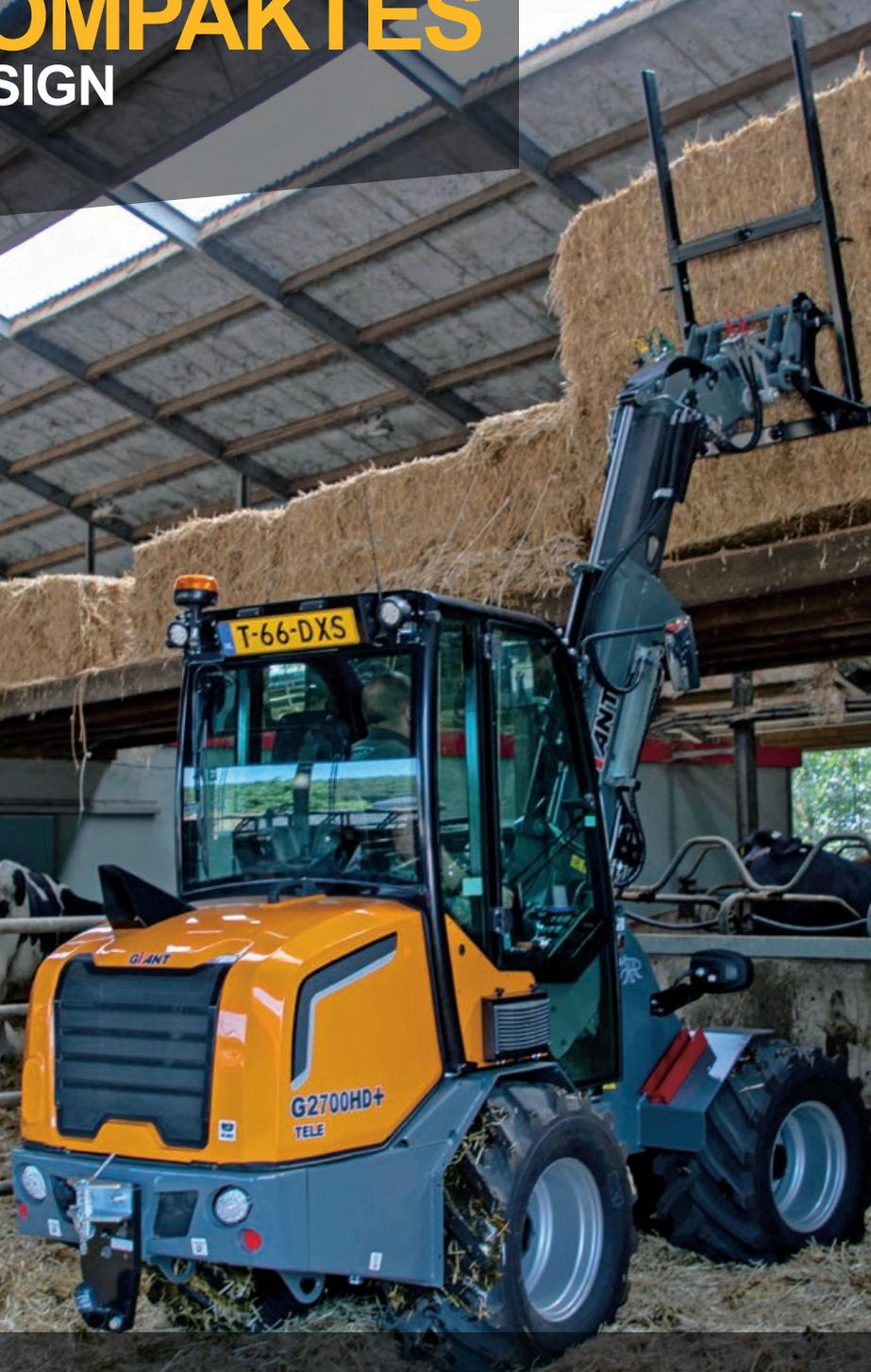
Die leistungsstarken G2700-Modelle sind dafür gebaut, um auf engstem Raum und schwierigem Untergrund zu arbeiten. Dafür sorgen nicht nur das niedrige Eigengewicht und die kompakten Ausmaße der Maschine, sondern auch das Knick- und Pendelsystem, welches den Maschinen kleine Wendkreise und eine extrem gute Manövrierbarkeit verleiht. Dies stellt sicher, dass sehr präzise gearbeitet werden kann.
